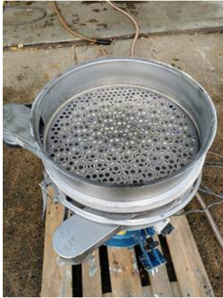
Bild 15 Vibrationstaumelsiebmaschine zur Untersuchung einer weitergehenden Feststoffseparation von Gärrest
