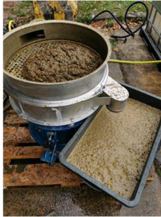
Bild 15 Vibrationstaumelsiebmaschine zur Untersuchung einer weitergehenden Feststoffseparation von Gärrest
