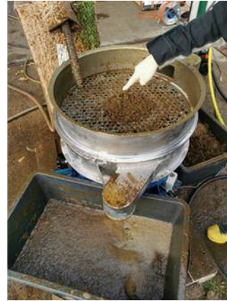
Bild 15 Vibrationstaumelsiebmaschine zur Untersuchung einer weitergehenden Feststoffseparation von Gärrest
