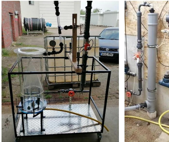
**Bild 10:** Speece-Cone-Einheit für die externe Sauerstoffversorgung (links) und externe Begasungseinheit/ Belüftungssäule (rechts)
