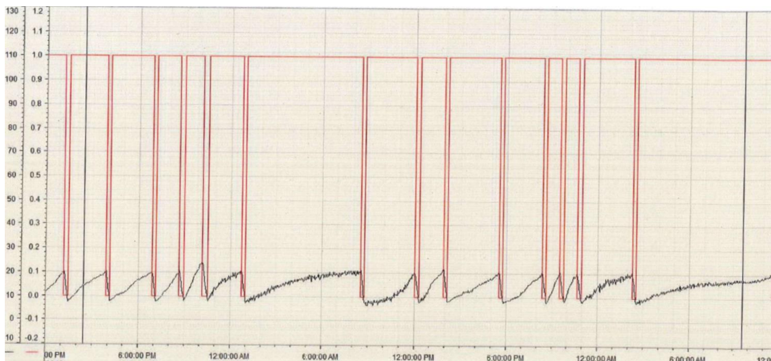
Bild 25 Beispiel für einen Screenshot der aufgezeichneten Tankfüllstände (schwarz: Füllstand; rot: Ventilstellung Auslass, 1 = zu, 0 = offen)
