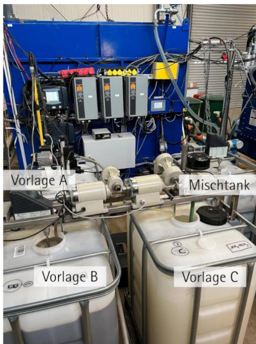
Bild 43 Fotos der zur Beschickung der Schiffskläranlage genutzten Abwassermisch- und Dosierstation
