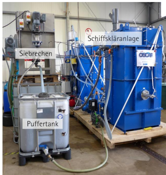
Bild 43 Fotos der zur Beschickung der Schiffskläranlage genutzten Abwassermisch- und Dosierstation
