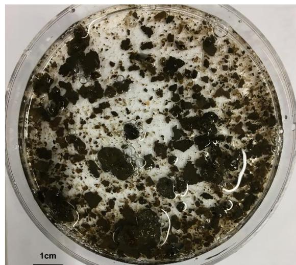
**Bild 71** Fotoaufnahme des granularen Schlammes aus dem SBR
